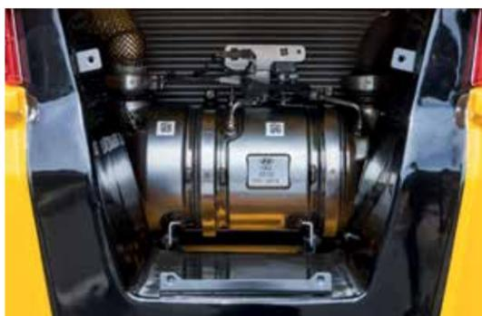
L'apertura del contrappeso è stata resa ampia il più possibile per aumentare la praticità di intervento. La soluzione **elimina l'esigenza di rimuovere il contrappeso** in occasione delle ispezioni o della sostituzione del dispositivo di post-trattamento dei gas di scarico.
