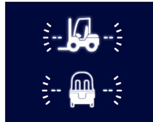
Pendant la conduite, l'unité de commande machine (MCU) détecte les mouvements longitudinaux et latéraux et **alerte le conducteur en cas de dépassement des valeurs de stabilité prédéfinies.**
