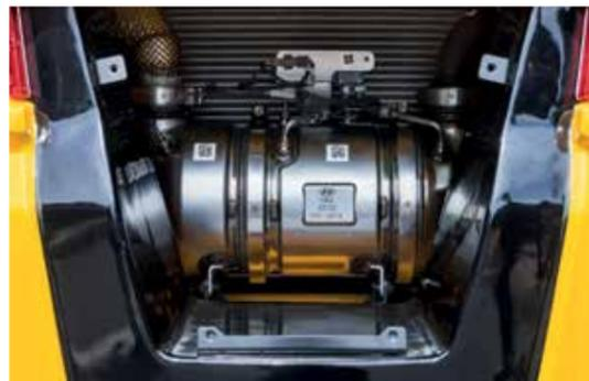
L'ouverture du compartiment du contrepoids a été agrandie au maximum. Il n'est **donc plus nécessaire de déposer le contrepoids** pour inspecter ou changer le dispositif de post-traitement.
